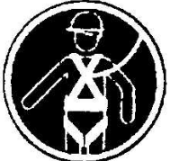
Protección individual obligatoria contra caídas
