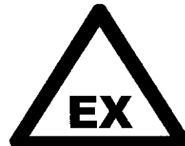
Zona de riesgos de atmósferas explosivas
